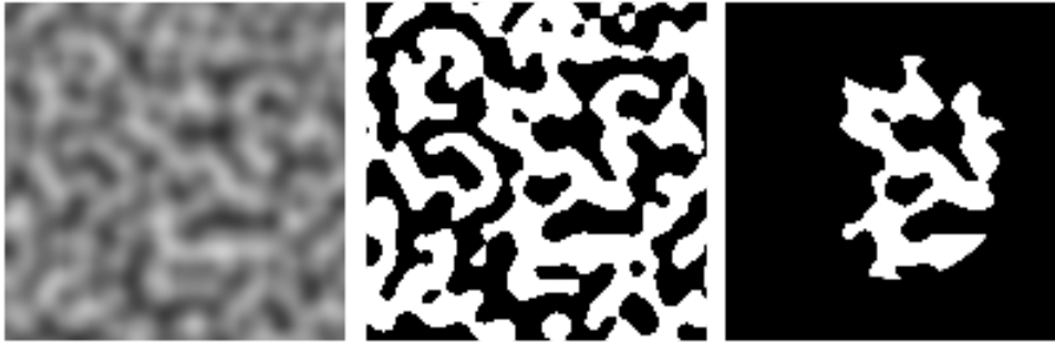
Figur 3: De tre stegen för generering av banan. Den vänstra bilden visar ett vanligt Perlin noise. I den mellersta bilden implementeras tröskelvärde som gör varje punkt svart eller vit. I den högra bilden används Flood fill för att plocka ut en sammanhängande del av banan inom en viss radie som sedan blir den slutgiltiga banan.
