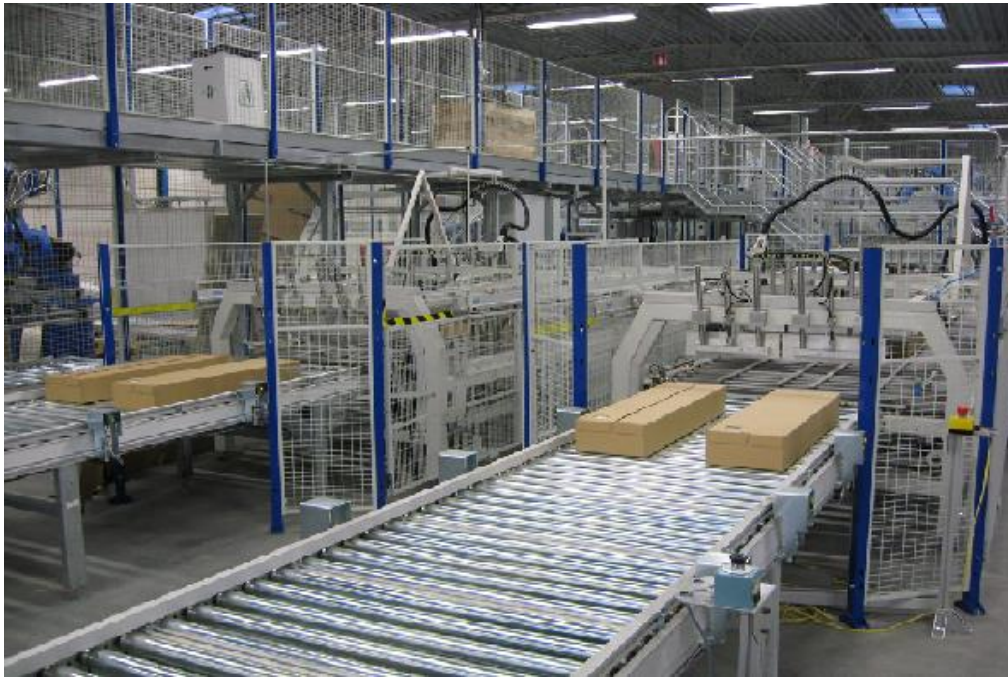
Bild 2: De fyra kartongerna har precis åkt igenom förslutarna och åker nu vidare för att staplas på en utgående pall. ( http://www.gyllensvaan.se/ )
