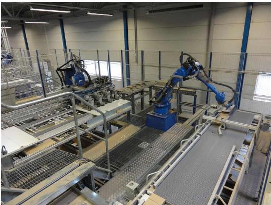
Bild 3: C-cellen med C1 och C4 (den lilla roboten). I mitten syns bordet som C4 lämnar beslagskartongerna på.
