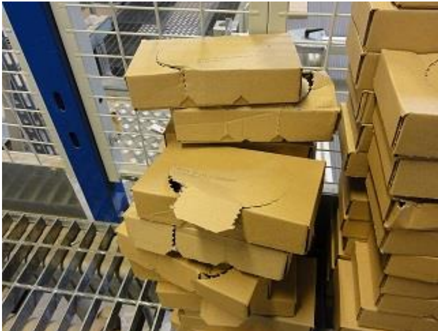
Bild 5: Ett exempel på hur det kan se ut på linan, dessa kartonger har operatörerna fått plocka ut från cellen för att roboten har stannat då den inte kunde plocka kartongerna p.g.a att perforeringen öppnats av roboten.
