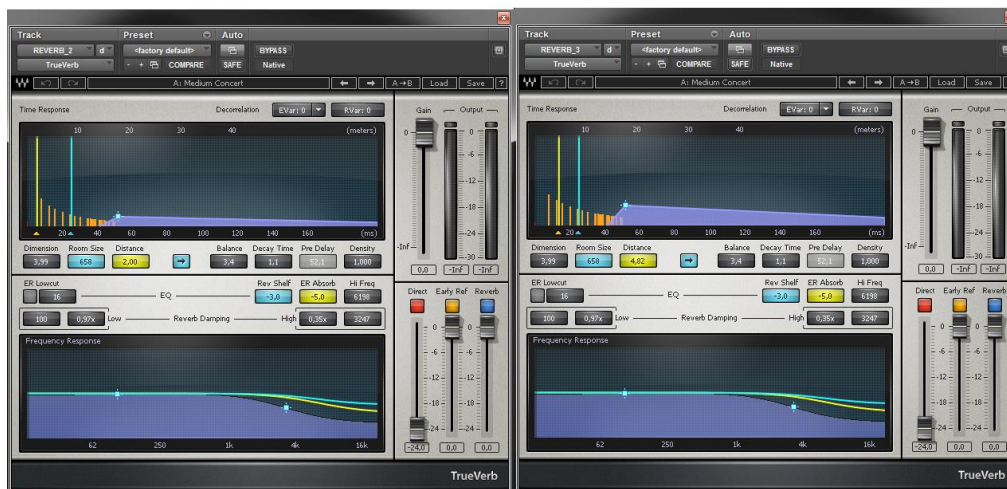
Figur 3 Bilden ovan visar inställningarna som användes för fördröjningsnättsreverben. Skärmdump av Waves TrueVerb.
