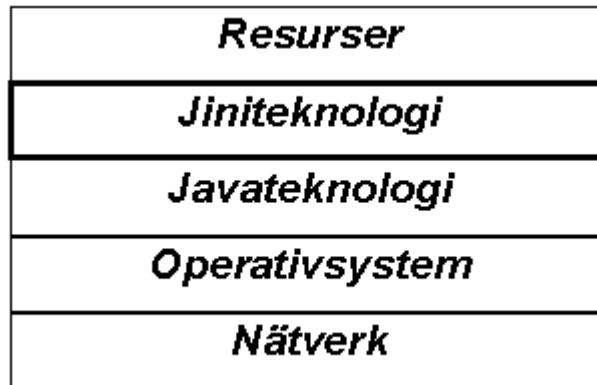
Figur 2-3: Jini är ett tillägg till Java som möjliggör integrering av resurser i en nätverksmiljö (Sun, 1999b)
