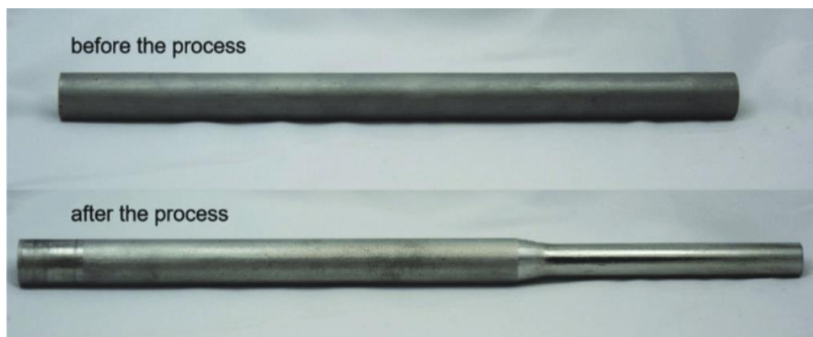
Figur 7 – Arbetsstycket före och efter bearbetningen av rotationspressning (Yang L & Jing L, 2020)
