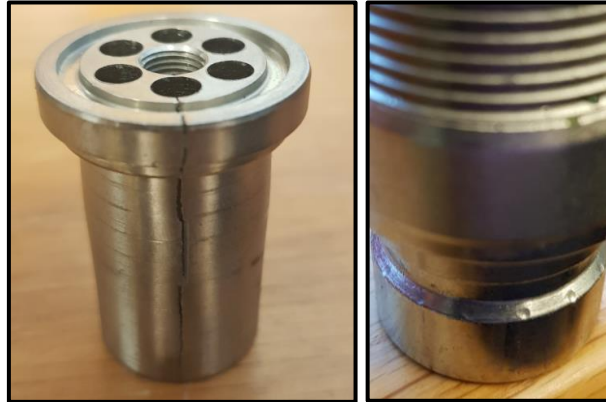
Figur 2.1.2. Styrningen efter haveri uppträtt, samt nippelhusets kulintryck.
